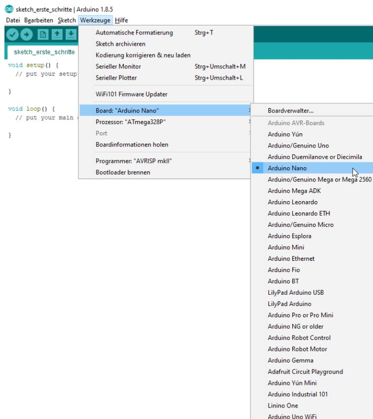
Wird nach dem Einschalten oder Reset des Mikrocontrollers einmalig aufgerufen und dient dazu das Verhalten von Pins zu konfigurieren (pinMode), Variablen zu deklarieren
